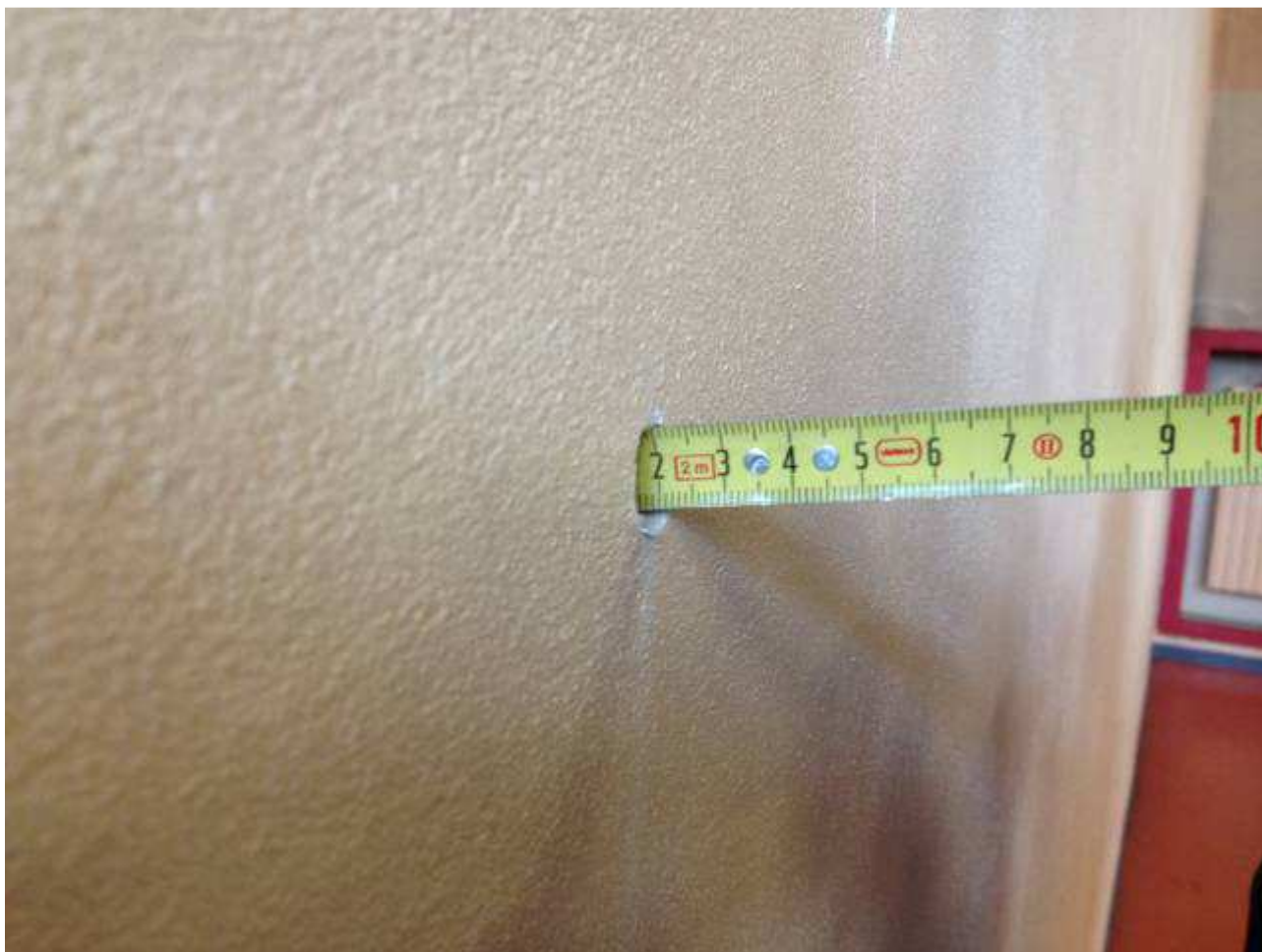
Foto 1) - Rif.to N.2 nelle planimetrie A e B allegate PALESTRA: MURO DI SEPARAZIONE CON IL TEATRO MATTEOTTI - RICOPRIMENTO del FERRO del PILASTRO 2 CM ad H 140 ( rif.to N.3 nella planimetria allegata)
