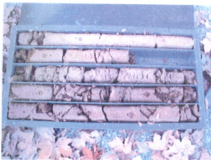
Foto 8: sondaggio S4 cassa 2 da m. 5.00 a m.10.00
