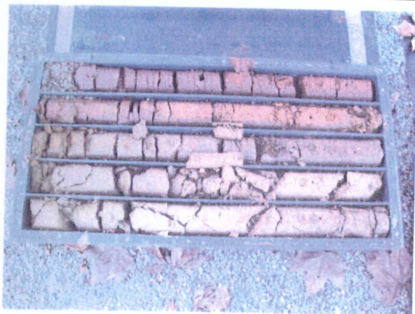
Foto 11: sondaggio S6 cassa 1 da m. 0.00 a m. 5.00
