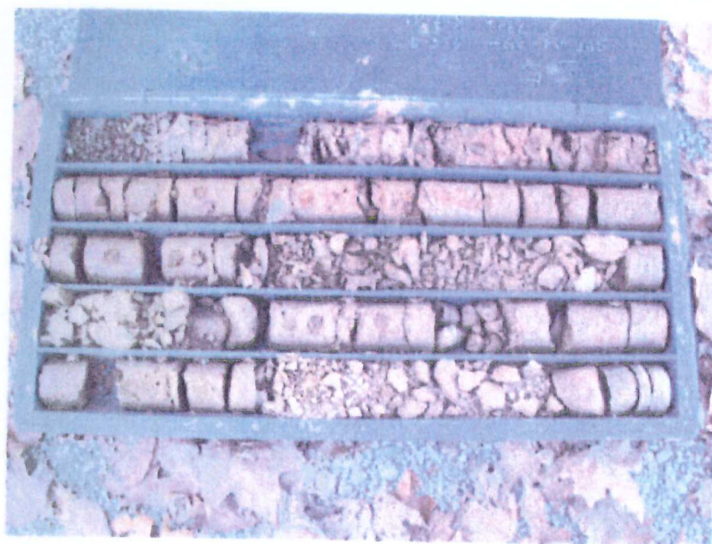
Foto 9: sondaggio S5 cassa 1 da m. 0.00 a m.5.00
