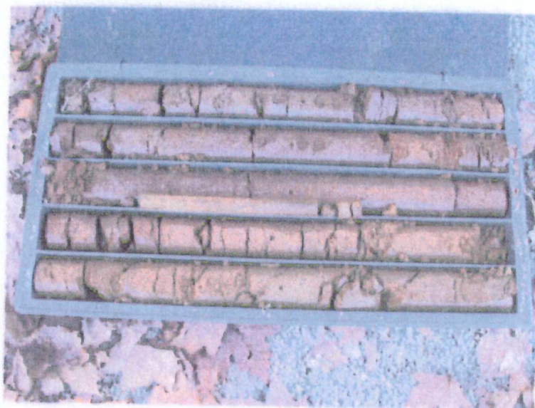
Foto 5: sondaggio S3 cassa 1 da m. 0.00 a m. 5.00
