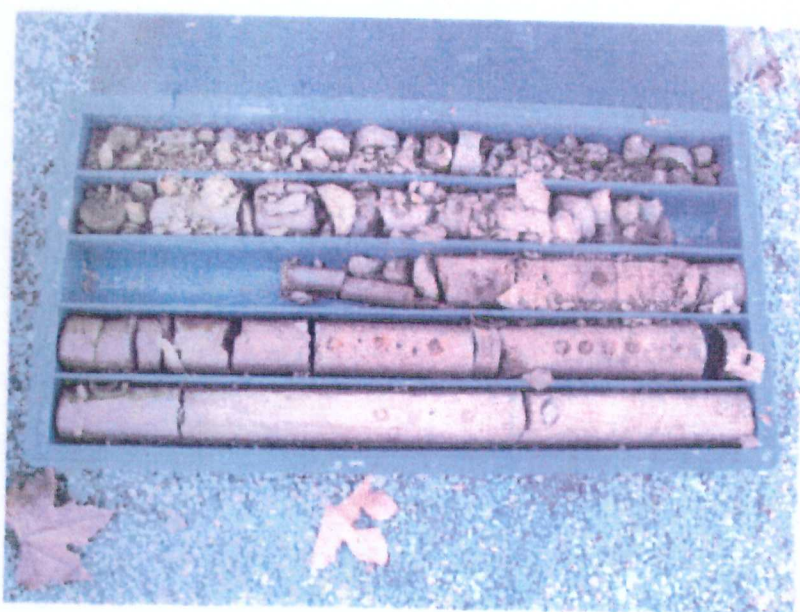
Foto 10: sondaggio S5 cassa 2 da m. 5.00 a m. 10.00
