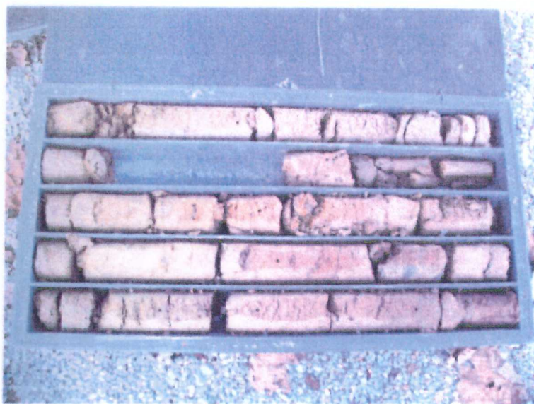
Foto 2: sondaggio S1 cassa 2 da m. 5.00 a m. 10.00
