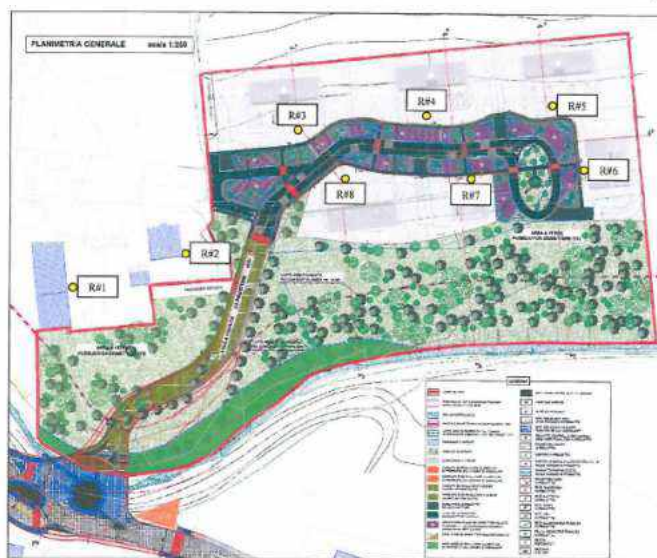
Figura 8-1 Planimetria generale di progetto con indicazione dei ricettori esposti al rumore del traffico indotto
